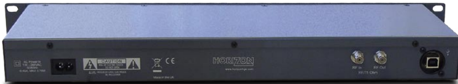
Achterpaneel van de transponder stream lezer met een tweede hoge snelheids USB interface en de antenne-ingang. Alle andere zaken worden afgehandeld door Rod Hewitt's aangepaste TSReader software
