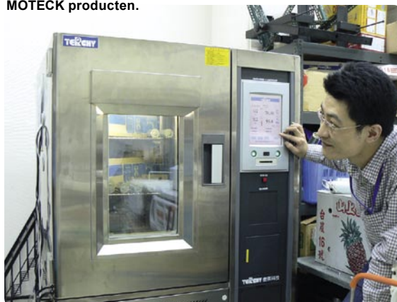
Testexemplaren worden van de productielijn afgehaald en getest in gecombineerde heet/koud klimaatkamers. Hier wordt de oven opgewarmd tot 70°C. Tests worden uitgevoerd van -40° tot +90°C.
