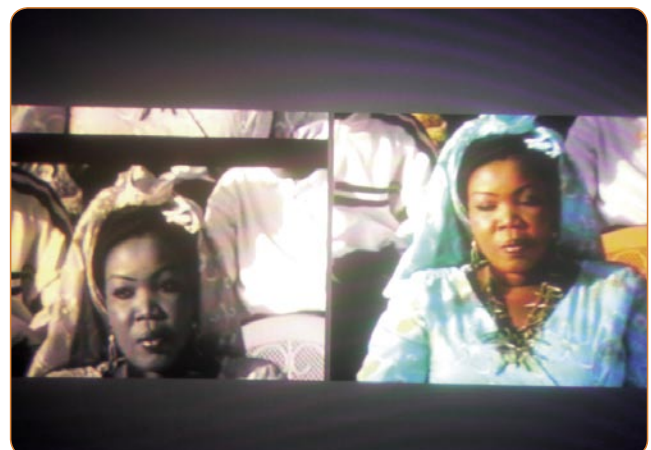
Tony kan twee ontvangers aansluiten door de video-ingangen van zijn Sony TV te splitsen. In dit voorbeeld zien we het PAL signaal van de Quali HD ontvanger in het linker beeld, het beeld rechts toont hetzelfde kanaal van een FortecStar ontvanger met een LNB splitter. Hierdoor kan hij zich ervan overtuigen dat PAL signalen correct worden omgezet naar NTSC.
