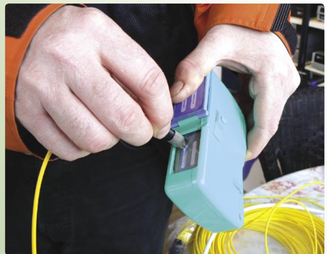
Een waarschuwend woord aan alle installateurs: Sluit nooit zomaar optische kabels aan – de aansluitingen van de kabels moeten perfect schoon zijn voordat ze verbonden worden. Om dit te bereiken kunnen diverse methodes gebruikt worden, de meest praktische is het gebruiken van het apparaat dat hier getoond wordt: de connector van de glasvezelkabel wordt er ingestopt en een hendel wordt dan bediend om de connector te reinigen met een bijzonder fijnkorrelig schuurpapier dat maar eenmaal gebruikt wordt. Dit is de enige manier om te garanderen dat een gemaakte verbinding zonder signaalverzakking tot stand komt.
