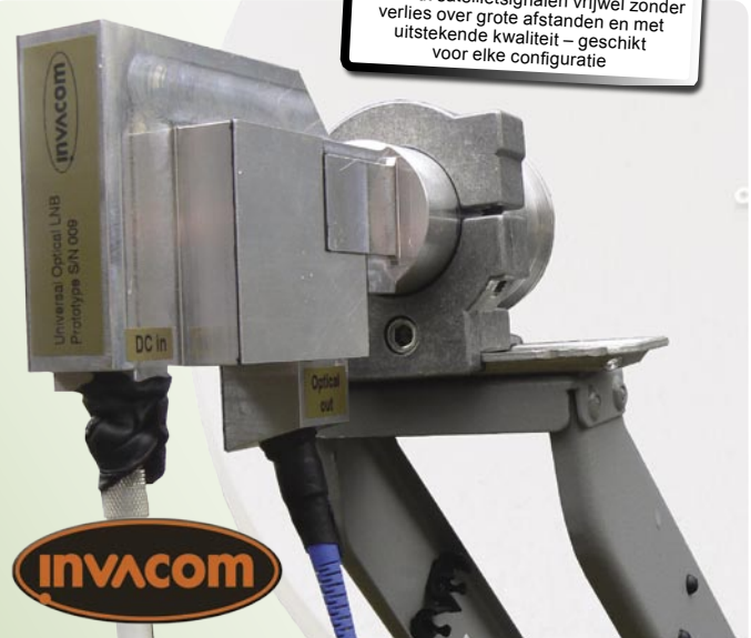
Optische LNB door Global Invacom – de 9e van slechts tien handgemaakte en volledig werkende prototype LNBs.
