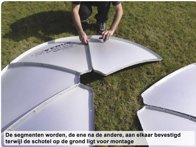
TELE-Satelliet testredacteur Sylvain Oscul begint met het assembleren van twee segmenten
