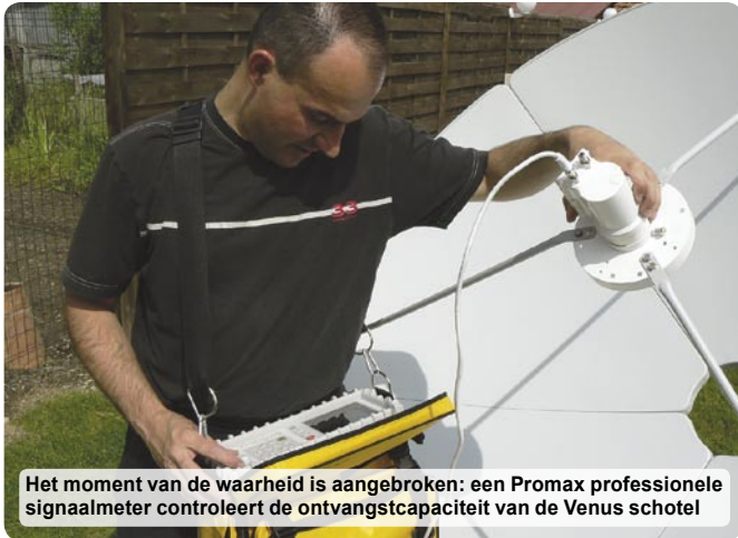
Welke LNB? PT Subur Semesta levert zijn schotel met een belangrijke verkortingsring. Op die manier kan je makkelijk de C band LNB uitwisselen met een standaard Ku band LNB.
