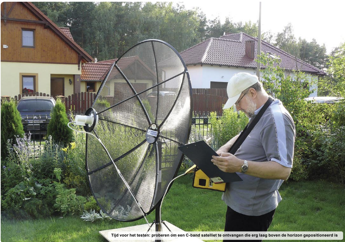
Tijd om de antenne af te stellen. Wij adviseren om een waterpas te gebruiken die voorzien is van een hoekmeter – dat maakt het instellen van de elevatie een stuk eenvoudiger
