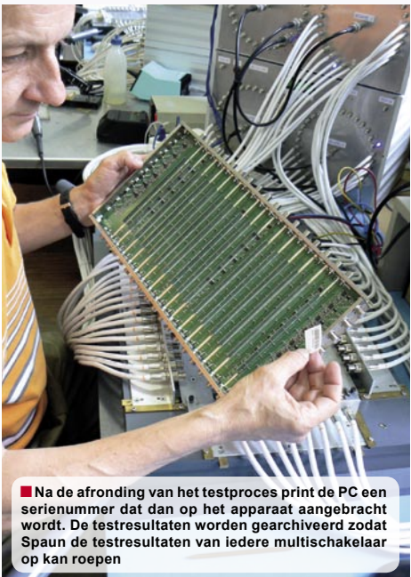
■ Iedere multischakelaar wordt op meerdere functies getest. De multischakelaar wordt in dit teststation gestopt en door een enkele hendel te verplaatsen worden alle "F" connectors aangesloten en kan het testproces beginnen
