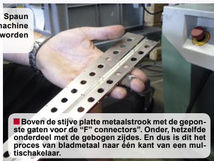
■ Waar gaat de printplaat heen? In een metalen behuizing, uiteraard. En waar komen die behuizingen vandaan? Hier, van deze productiemachine waarop een rol bladmetaal van 30mm breed en 0,7mm dik met een 0,02mm nikkel coating zit. Een nieuwe rol weegt ongeveer 100Kg en is 400 m lang.
