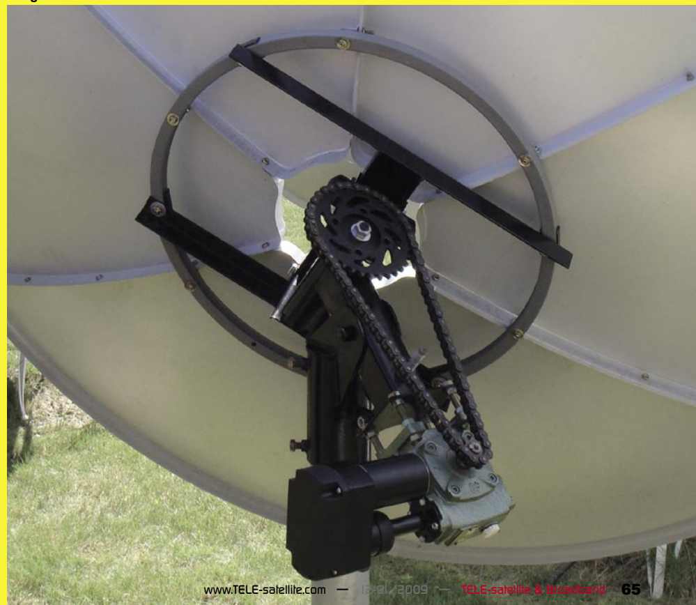
■ Grote schotels hebben een zware motor nodig – de Venus motor van Subur Semesta uit Indonesië getest met een Venus schotel
