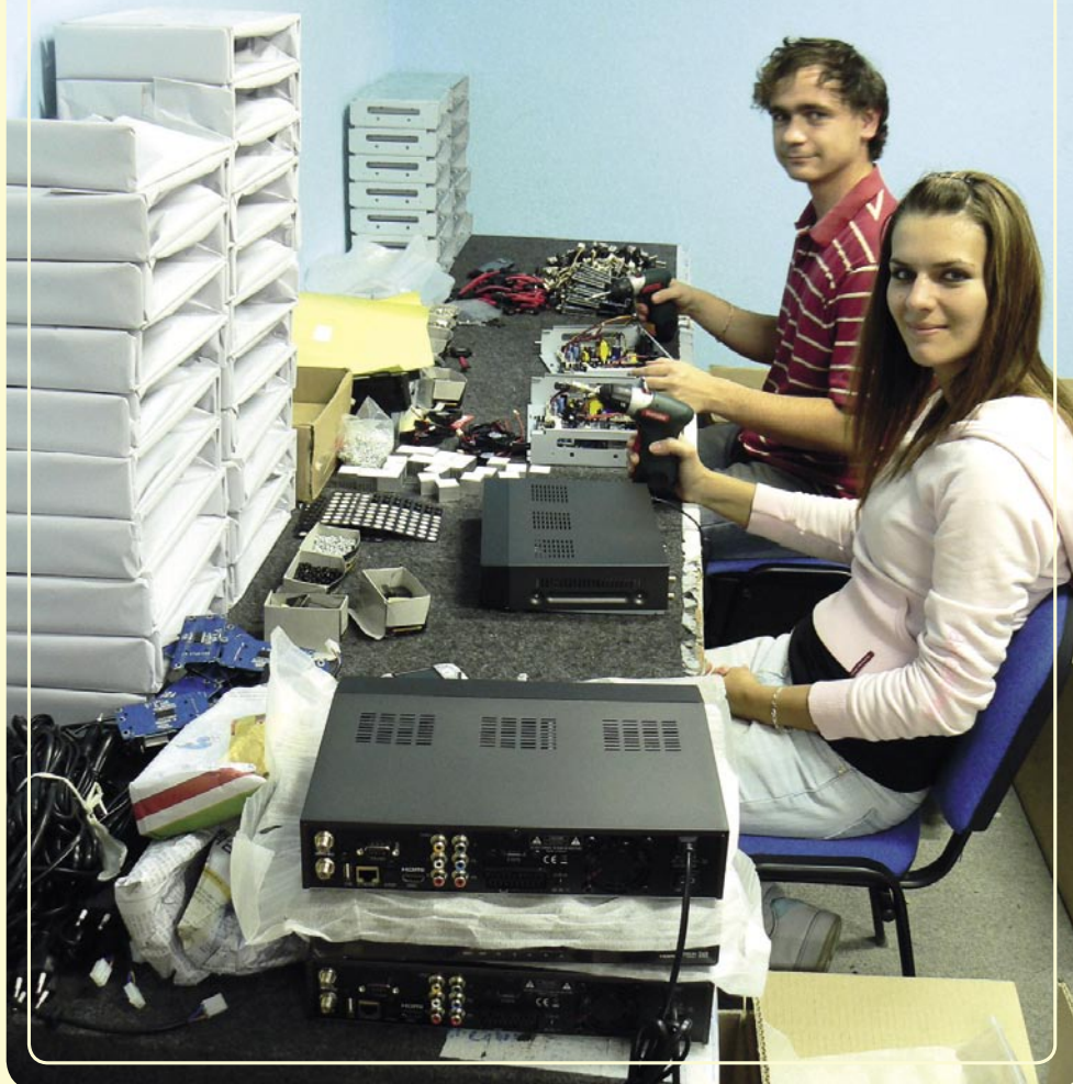
■ Een blik op een gebied in het assembleergebied. Dit is waar de extern aangeleverde componenten door 16 werknemers worden samengevoegd totdat een voltooide AB-COM ontvanger individueel op prestaties getest kan worden.
