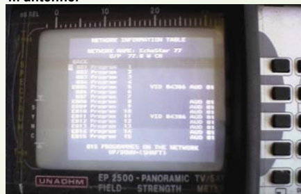
■ Diego's satellietmeter toont de NIT tabel van één van de transponders van de ECHOSTAR 6A die hij ontvangt.
