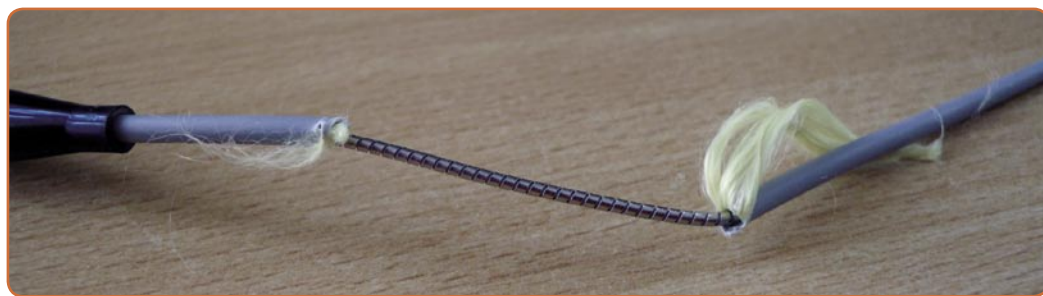
Metalen beschermhuls om de glasvezelkabel te beschermen
