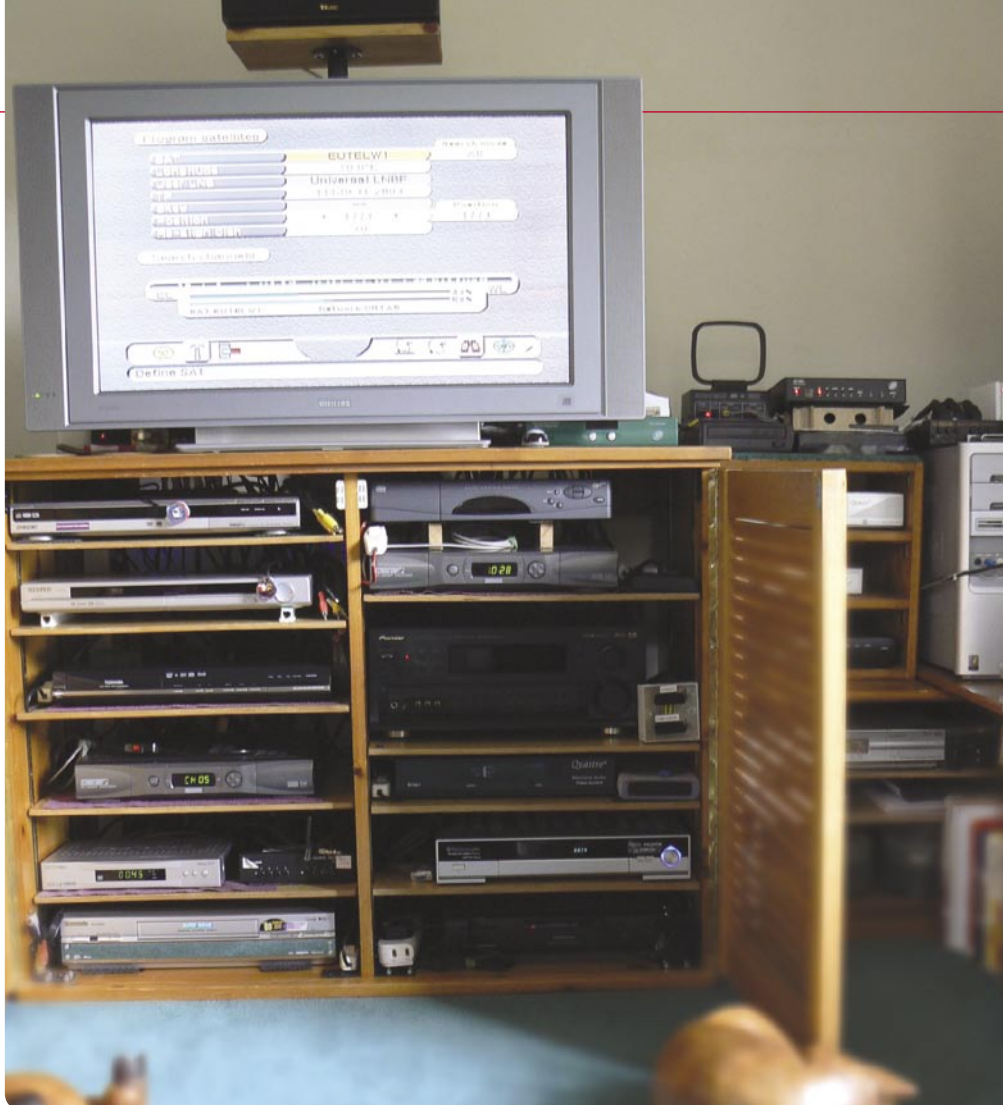
■ Roy opende de kast in zijn woonkamer voor deze foto: hier vind je de zes ontvangers en ook een DVD speler. "Om snel een software-update te kunnen uploaden heb ik aan elke ontvanger een null modem kabel aangesloten en deze naar de voorkant geleid", zegt Roy terwijl hij naar de aansluiting onder elke ontvanger wijst.
