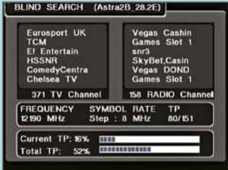
De blind scan mogelijkheid kan transponders vinden die nog niet in de voorgeprogrammeerde lijst staan |
