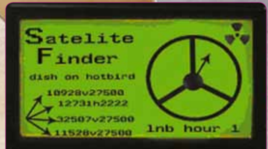
■ Het display van de intelligente satellietvinder die de sterkste transponders toont samen met de schuif van de LNB.
