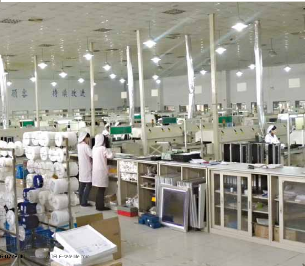
■ Aan de andere kant zijn de rollen met de surface mount componenten. Deze worden door een medewerker ingevoerd in de geautomatiseerde SMT plaatsingsmachines. Deze automatische SMT machines draaien 24 uur per dag. De Chinese spreuk op de muur in de achtergrond betekent: "Werk samen met uw collega-werknemers, Goed management, Klantgericht, Continue verbetering".
